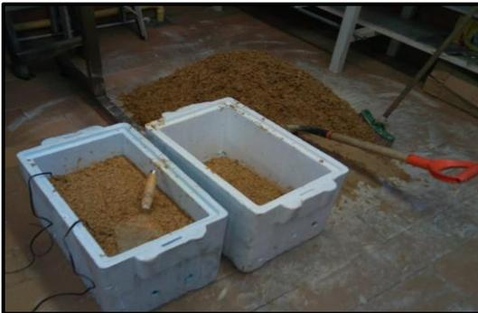
*Figura 8. Ubicación de electrodos para medición de resistividad eléctrica del sustrato.*
